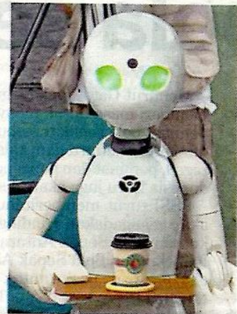
ROBOT digelar Orihime-D ini mempunyai kamera dan mikrofon di bahagian kepalanya.
